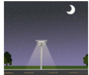
La luminaria mantiene el 10% de brillo cuando no detecta una presencia después de 30s las primeras 4 horas.
